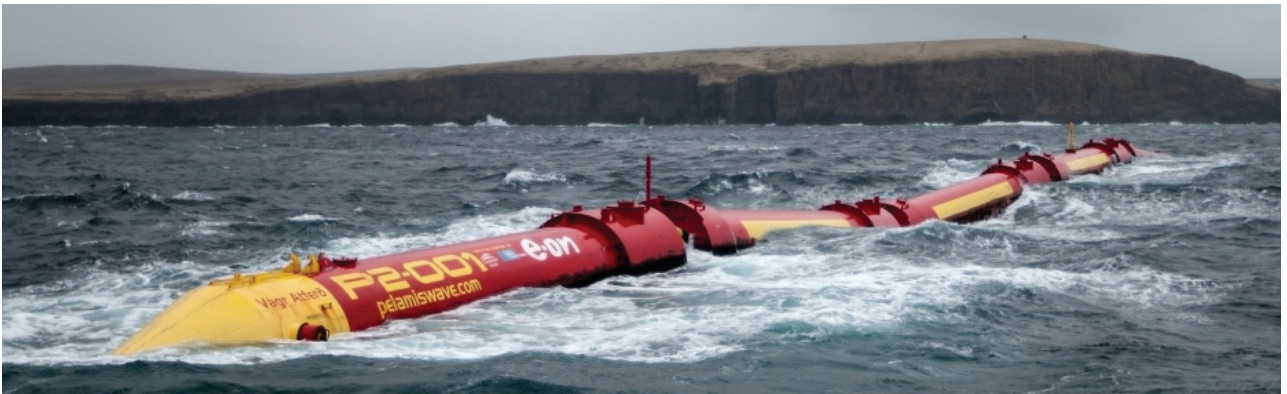
Fig. 7 Typical W. E. converter: Pelamis UK.
