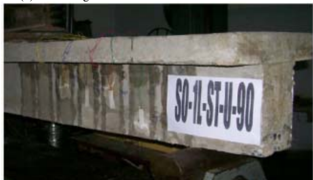
(d) Debonding and rupture failure of GFRP strips
